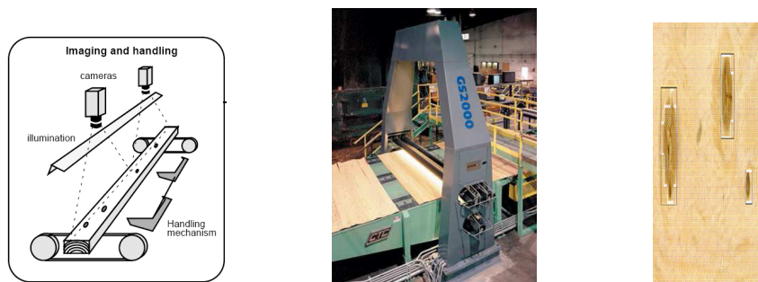
Figura 1.3: Sistema automático de detección de nudos en tablones de madera.
