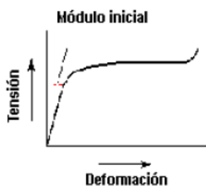
Figura 31: Gráfico de tensión y deformación para un polímero flexible.
