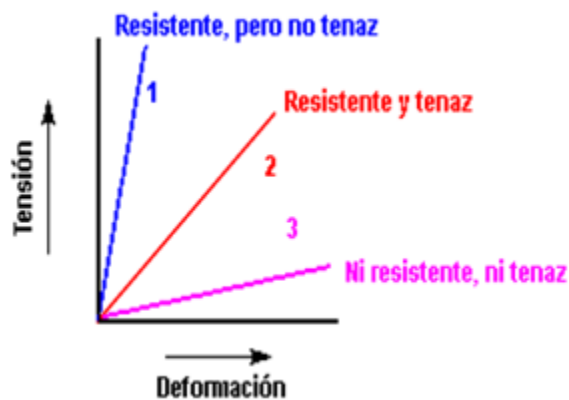
Figura 33: Comportamiento mecánico de varios tipos de polímeros.
