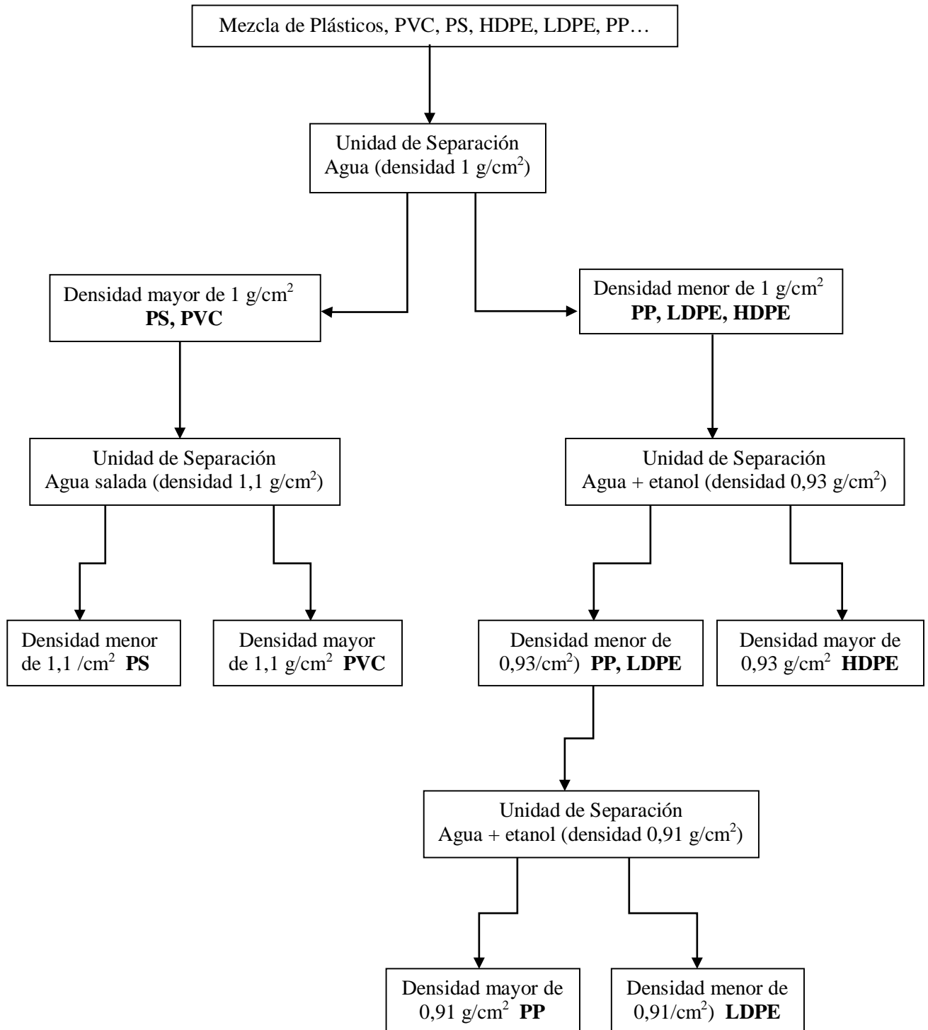
Figura 35: Esquema general de la separación de residuos plásticos mediante flotación.
