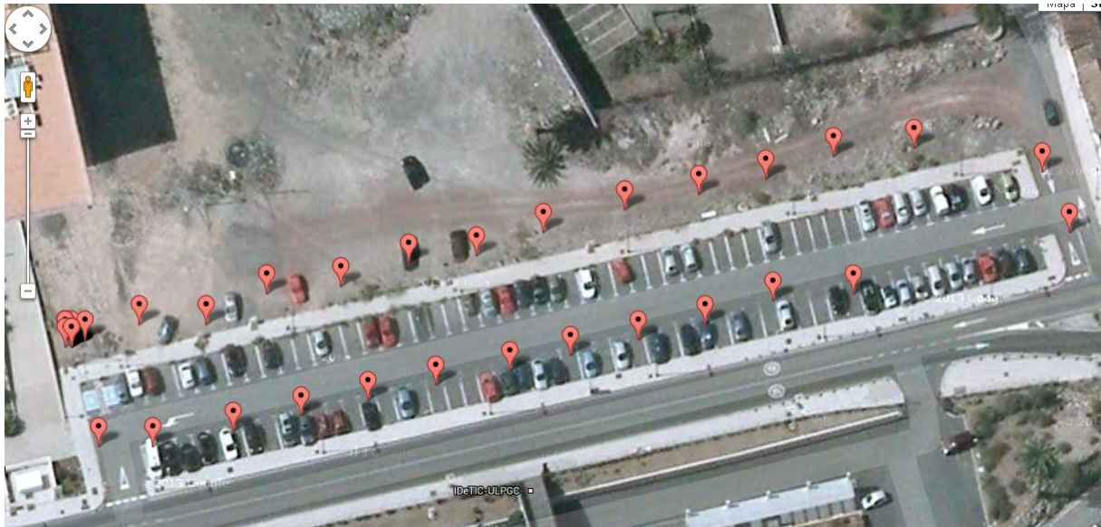
Fig. 20 – Ejemplo de la precisión de los datos obtenidos por el GPS de los Waspnote
