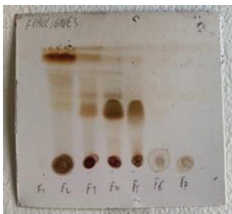
Figura 34. TLC de las 7 fracciones obtenidas. Esta imagen muestra que se sacó una séptima fracción, aunque ésta se unió a la F6.
