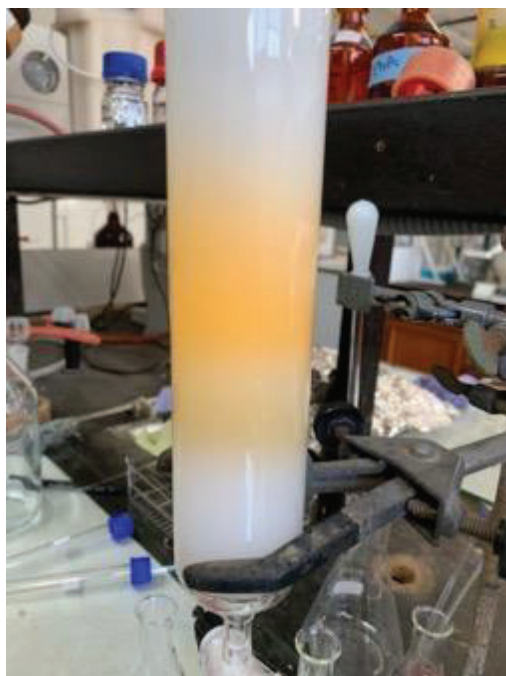
Figura 31. Columna cromatográfica de exclusión molecular Sephadex LH-20. Se observan distintas bandas de color como consecuencia del fraccionamiento de las moléculas que componen la muestra. Cada banda de un color es un grupo de compuestos con pesos moleculares similares.
