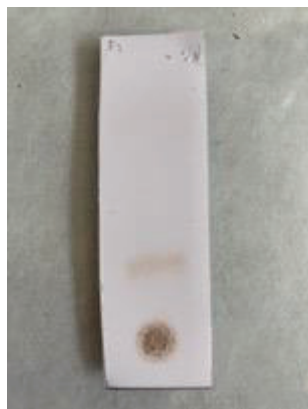
Figura 35. TLC de F2 del extracto de n -hexano de HB con fase móvil n -hexano: acetato de etilo (95:5)
