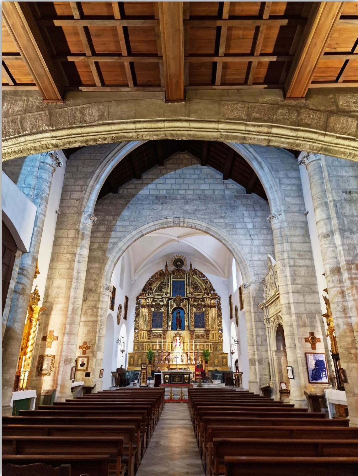
Fotografía 7.36: Iglesia de Santiago (Calle de las Tiendas, nº 8, Almería). La construcción, del siglo XVI, tiene techo lignario a dos aguas, del tipo par e hilera, apoyados en arcos diafragmas de cantería, que asumen las funciones de los nudillos y de los tirantes. Las caras internas de este techo son de alfarjes, con jácenas, jaldetas y tablazones. El tramo inicial de la nave se encuentra bajo un sub techo lignario plano, también de alfarjes, con vigas, travesaños y tablazones de madera. Los techos de esta Iglesia son de reposición. Reemplazaron a la techumbre original, que resultó incendiada durante la Guerra Civil de 1936-1939. Los techos de reposición intentaron reproducir, lo más fielmente posible, a los originales (según la comunicación personal del 9 de diciembre de 2023, de don Javier Morcillo, de la Hermandad de la Soledad, en la sacristía de la Iglesia). Captura del 9 de diciembre de 2023.
