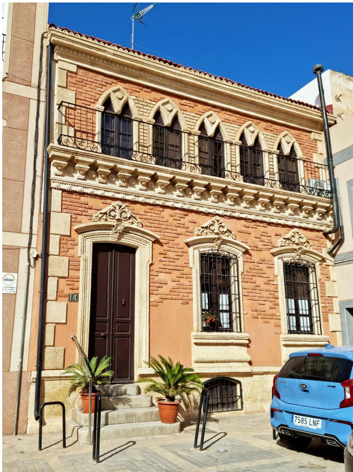
Fotografía 8.261: edificio modernista en la plazuela llamada Calle Orbaneja (en el entorno de la Calle Granada), de ladrillo a la vista, y con ornatos arquitectónicas en cantería, tales como ménsulas lobuladas en rectángulos, jambas y arcos escarzanos con acróteras, arcos ajimeces con geometría túmida (conforme con los dibujos de De la Plaza Escudero, 2013), cornisa intermedia estriada sobre numerosos canchillos y esquineras dentadas, entre otros elementos, algunos de ellos con decoraciones florales, entre otros motivos. Captura del 22 de julio de 2022.
