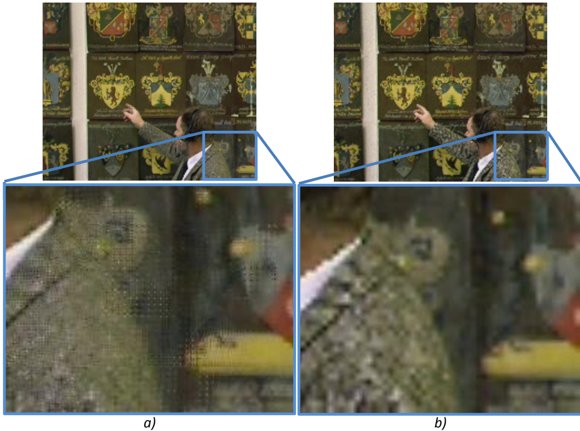
Figura 5.19.- Frames nº 14 súper-resuelto (a) e interpolado (b) HR para la secuencia Shields en el método Temporal Espacial en modo Overlap+Borders
