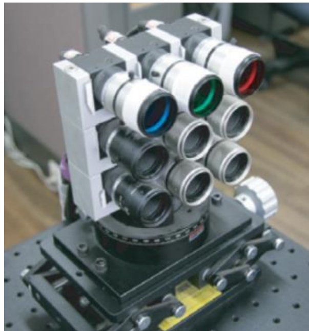
Figura 2.23.- Array MC de dimensiones 3x3 del Instituto Universitario de Yonsei [HMG08]
