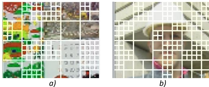
Figura 3.20.- División de MBs en frames de las secuencias Mobile (a) y Foreman (b) usando VBS
