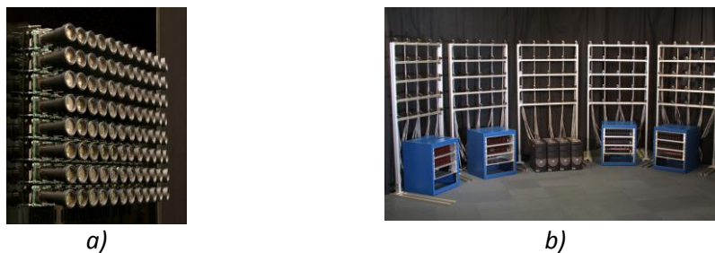
Figura 2.15.- Arrays MC de la Universidad de Stanford. a) Array MC con teleobjetivos de dimensiones 8x12 y b) Array MC donde las cámaras tienen una amplia separación
