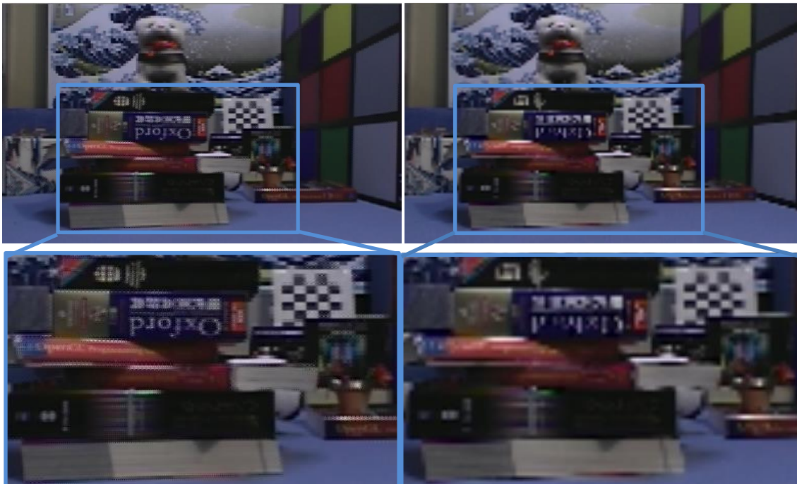
Figura 5.40.- Frames súper-resuelto (a) e interpolado (b) HR para la secuencia Fujidog aplicando SR Espacial en modo Full-Frame
