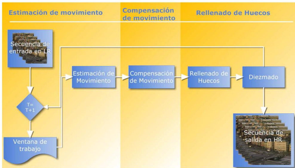
Figura 3.2.- Diagrama de bloques de algoritmo de SR dinámica tomado como referencia
