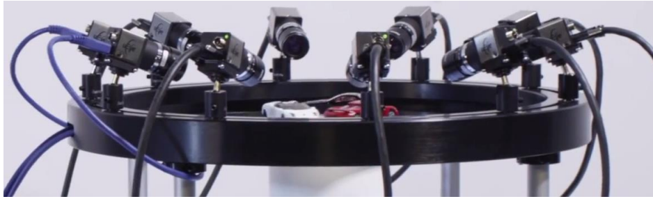
Figura 2.19.- Sistema MC de la empresa IDS® a través de USB 3.0
