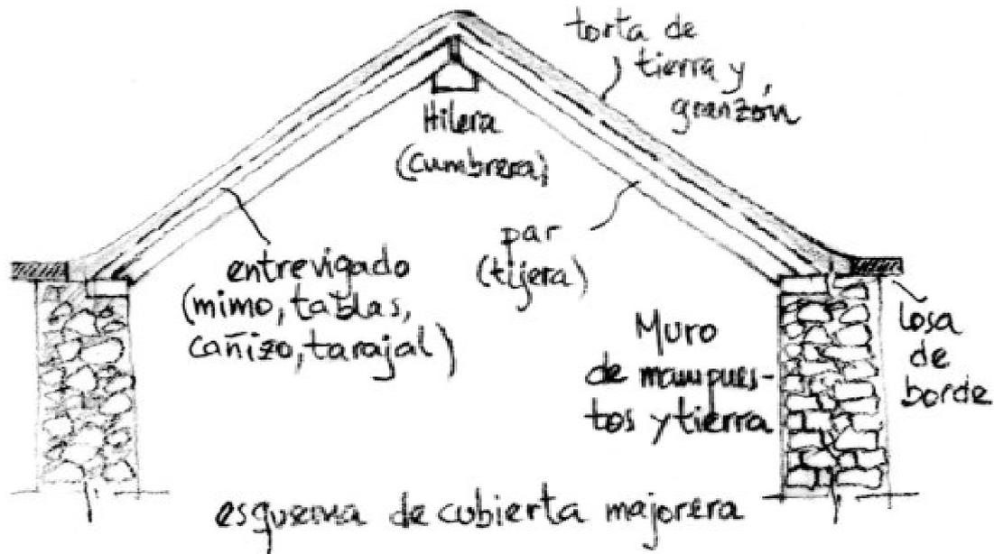
Figura 141: Croquis de cubierta terminada con torta de tierra. (Guigou Fernández 2005)
