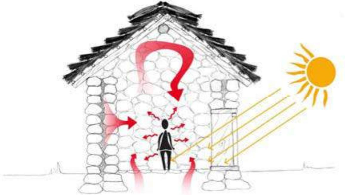
Figura 102: Estrategia bioclimática de casa pajiza en invierno: El calor acumulado en el terreno y los muros - gracias a su alta inercia térmica- ayuda a mantener una temperatura constante junto con las ganancias solares y de cargas internas, con una ventilación mínima producida a través de los desajustes de las carpinterías y la permeabilidad de la cubierta. Elaboración propia.
