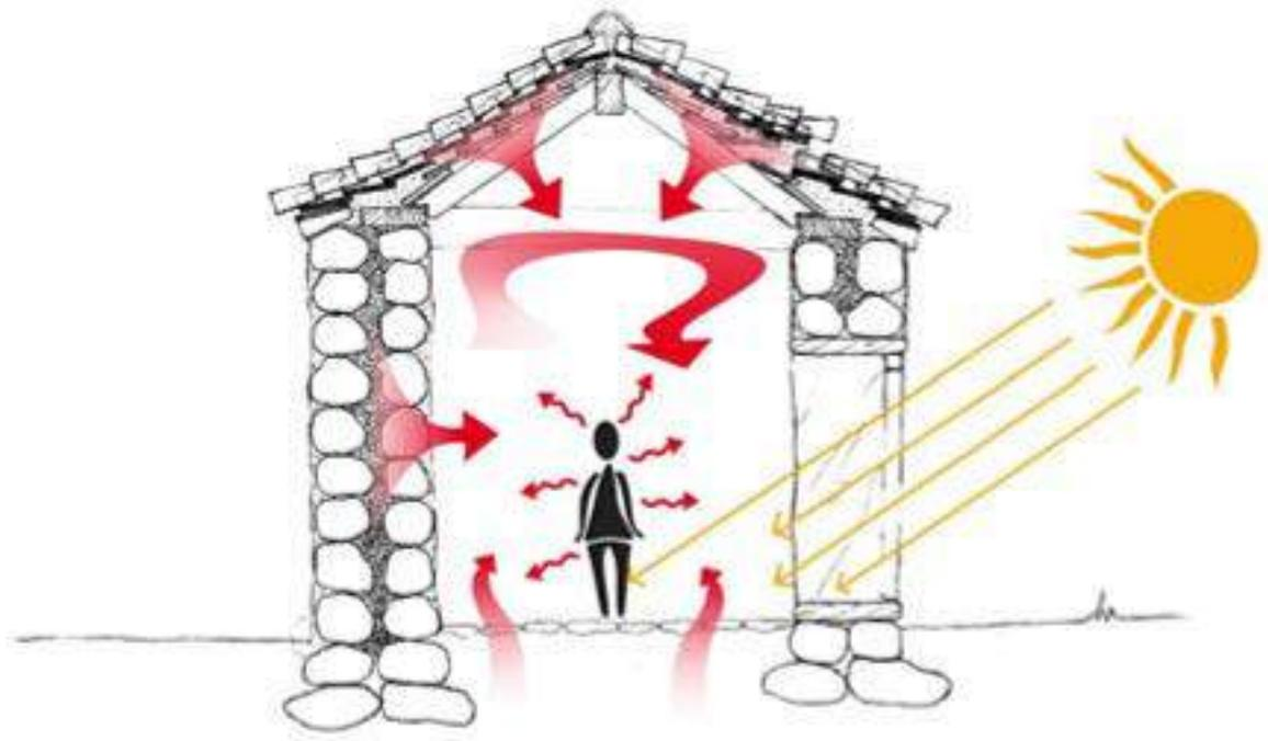
Figura 122: Estrategia bioclimática de casa de tejas en invierno. El calor acumulado en el terreno, los muros y la cubierta -gracias a su alta inercia térmica- ayuda a mantener una temperatura constante, junto con las ganancias solares y de cargas internas. Se garantiza una mínima renovación del aire gracias a los desajustes de las carpinterías y a la permeabilidad de la cubierta. Elaboración propia.
