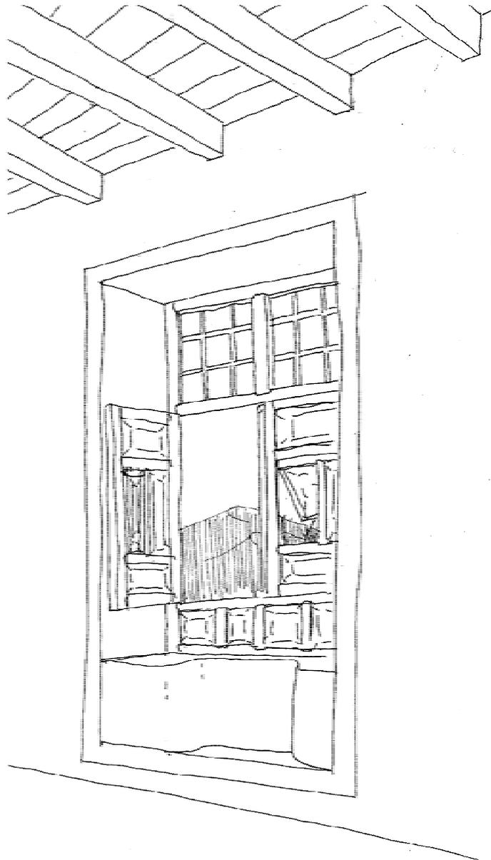
Figura 208: Ventana lanzaroteña con poyetes practicados en el ancho del muro. (Cárdenas y Chávarri, Gil Crespo y Maldonado Ramos 2007)
