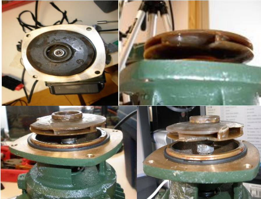
Figura 10: Fotos del fallo en el plato del rodete. Rodete sin fallo (superior izquierda), rodete con una parte del plato eliminada (superior derecha), rodete con dos partes de plato eliminadas (inferior izquierda) y rodete con tres partes de plato eliminadas (inferior derecha).
