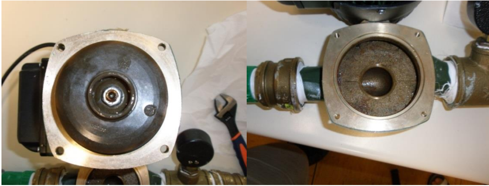
Figura 9: Fotos de la bomba de agua modelo ALP 800. Rodete montado en el rotor (izquierda). Voluta, entrada y salida de la bomba (derecha).
