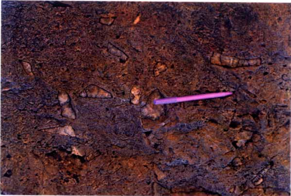
Figura 2.68 - Xenolitos prismáticos de aspecto cuarcítico englobados en la lava del tramo 4.
