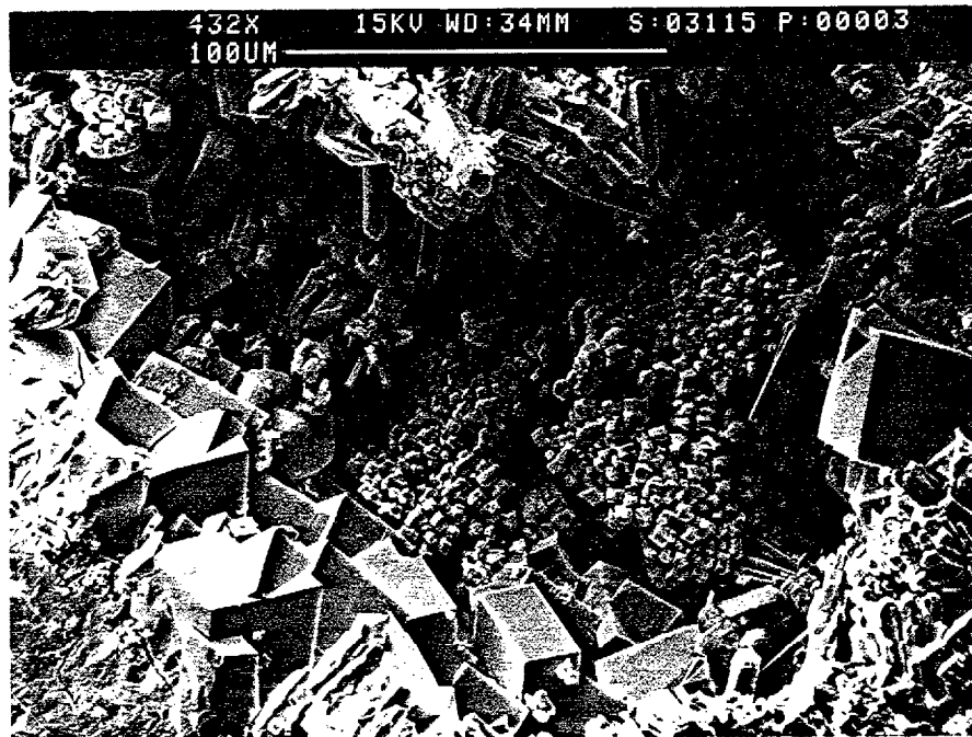
Figura 5.22 - Agregado de cristales pseudocúbicos de chabacitas y prismáticos de phillipsitas tapizando el interior de un fragmento cinerítico.
