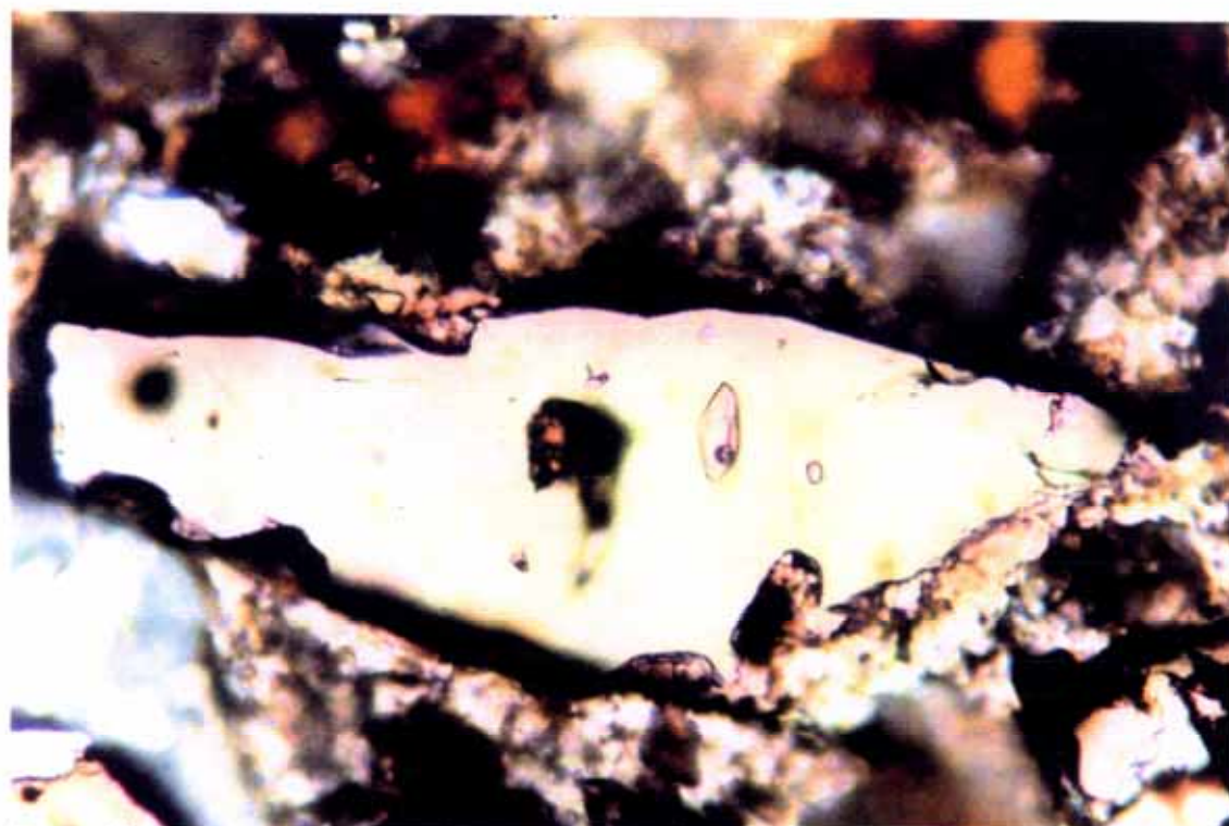
Figura 6.20 - Clinopiroxeno conteniendo inclusiones vítreas poco o nada evolucionadas bifásicas (vidrio y burbuja de contracción) (NP, x200).
