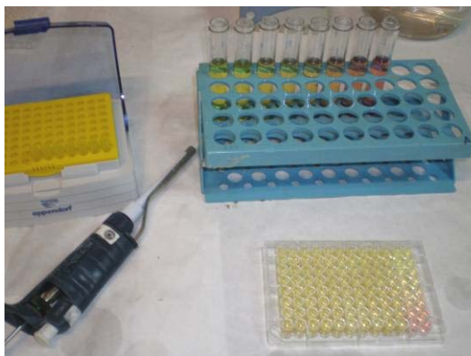
Figura 12: Reacción colorimétrica de la hidroxiprolina previa medición en el espectrofotómetro. En la gradilla los estándares y en la placa las muestras y los estándares.
