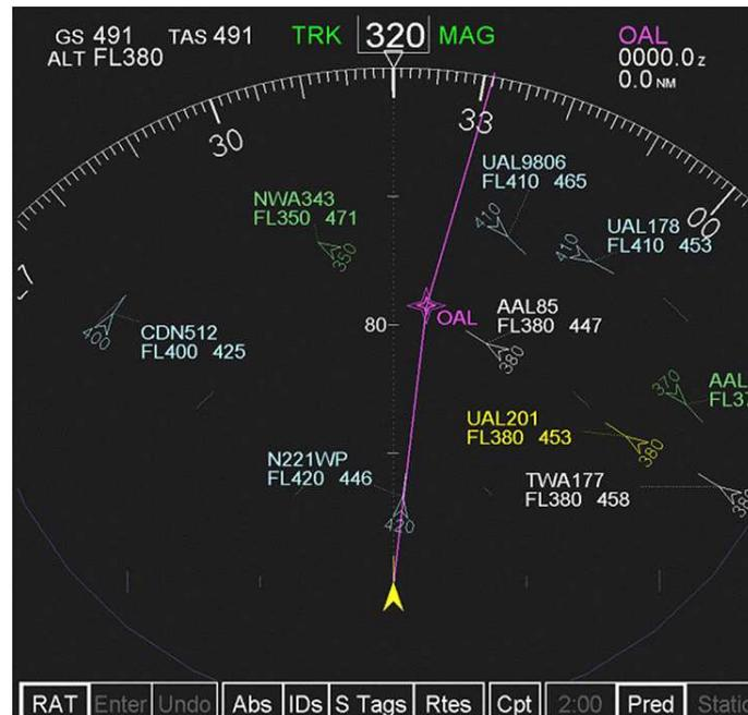
Figura 1.6: Prototipo de pantalla CDTI
