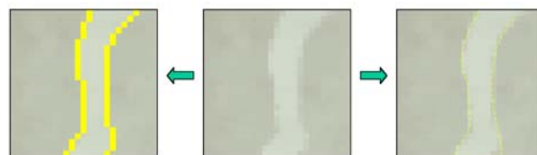
Figura 3: Contornos detectados en una angiografía a nivel píxel (izquierda) y a nivel subpíxel (imagen derecha)
