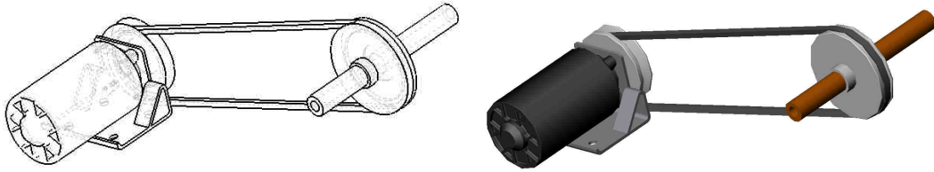
Figura 5.6: Diseño de sistema de movimiento de giro del molde de la máquina de rotomoldeo.
