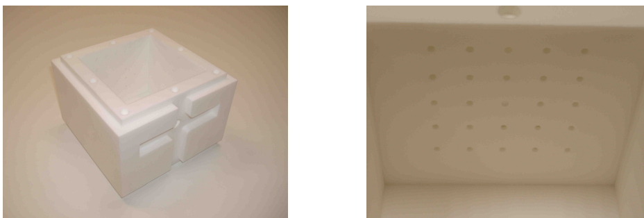
Figura 4.31: Manifold fabricado mediante sinterizado y detalle de aberturas de salida de aceite del manifold.
