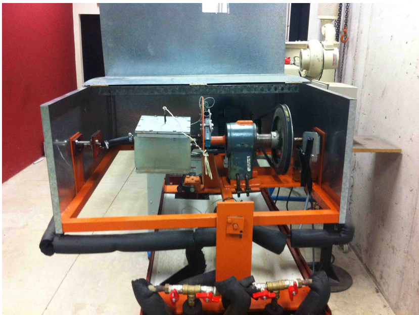
Figura 5.19: Imágenes varias reales de la máquina de moldeo rotacional fabricada incluyendo carcasa exterior de protección.
