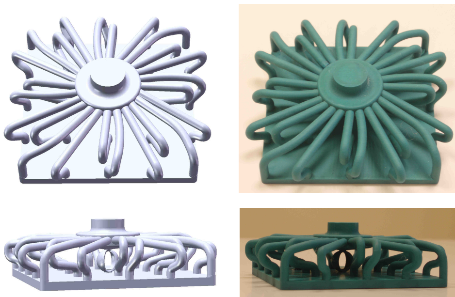
Figura 4.26: Imágenes de los canales interiores del manifold. Diseño (izquierda) y modelo fabricado en cera (derecha)
