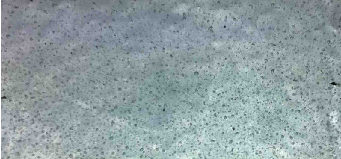
Figura 6.59: Imagen ampliada de cara inferior o fondo de piezas número 27 a 140 °C y 15 minutos de calentamiento.
