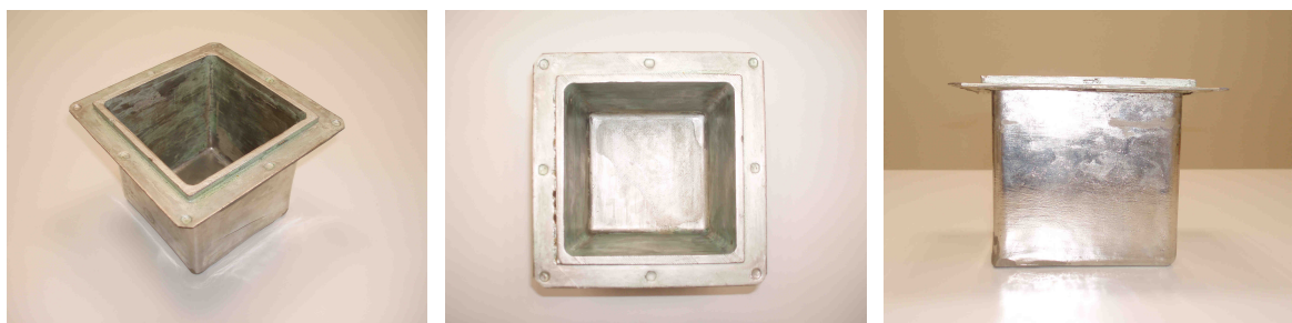
Figura 4.21: Imágenes de la cavidad interior electroconformada.
