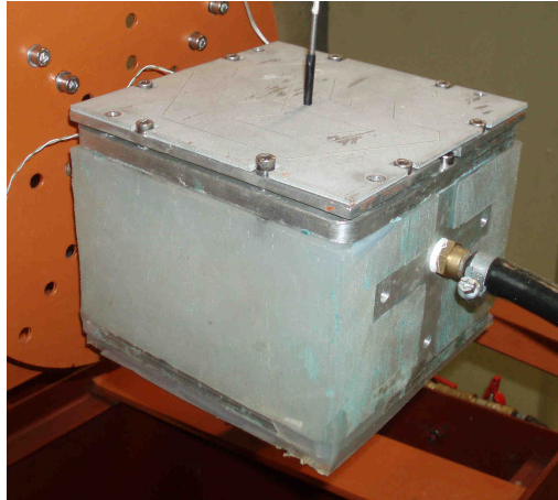
Figura 4.32: Vistas varias de diseño final de molde de rotomoldeo completo de calentamiento por aceite a través de canal envolvente, manifold octopus y cavidad interior del molde de níquel de 1 mm.
