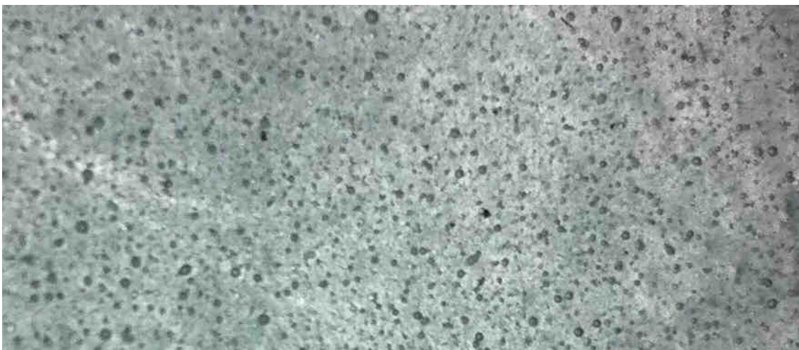
Figura 6.57: Imagen ampliada de cara inferior o fondo de pieza número 25, a 160 °C y 40 minutos de calentamiento.
