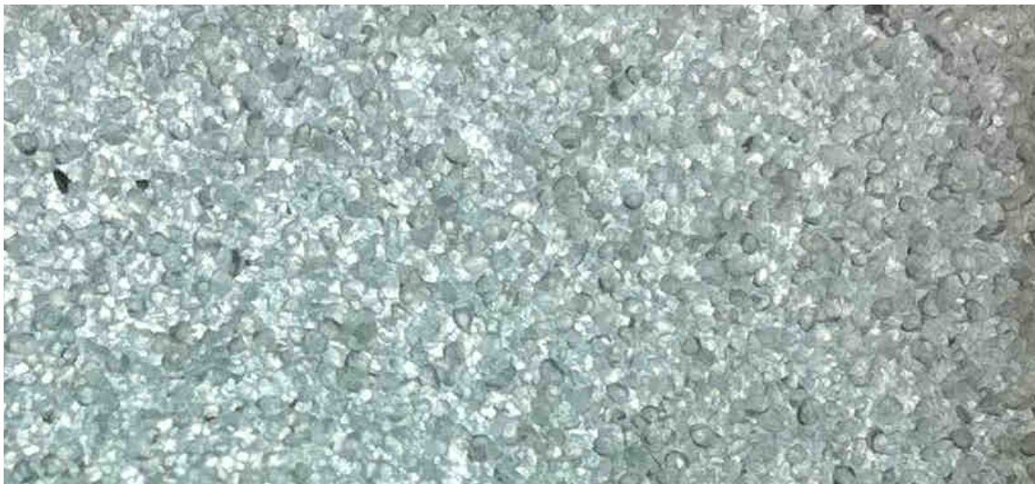
Figura 6.51: Imagen ampliada de cara inferior o fondo de pieza número 18, a 140 °C y 15 minutos de calentamiento.
