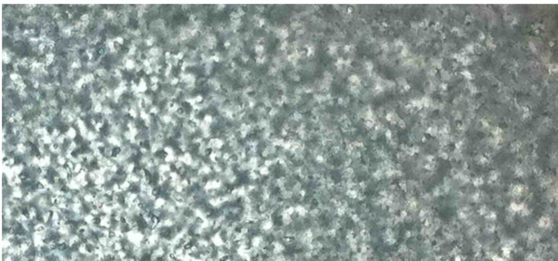
Figura 6.55: Imagen ampliada de cara inferior o fondo de pieza número 23, a 160 °C y 15 minutos de calentamiento.
