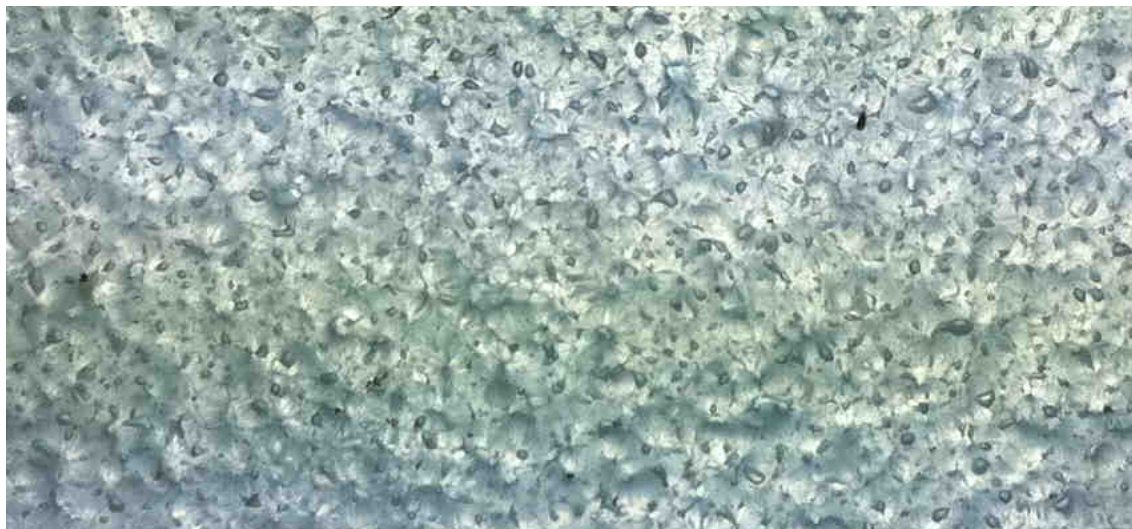
Figura 6.53: Imagen ampliada de cara inferior o fondo de pieza número 21, a 140 °C y 40 minutos de calentamiento.
