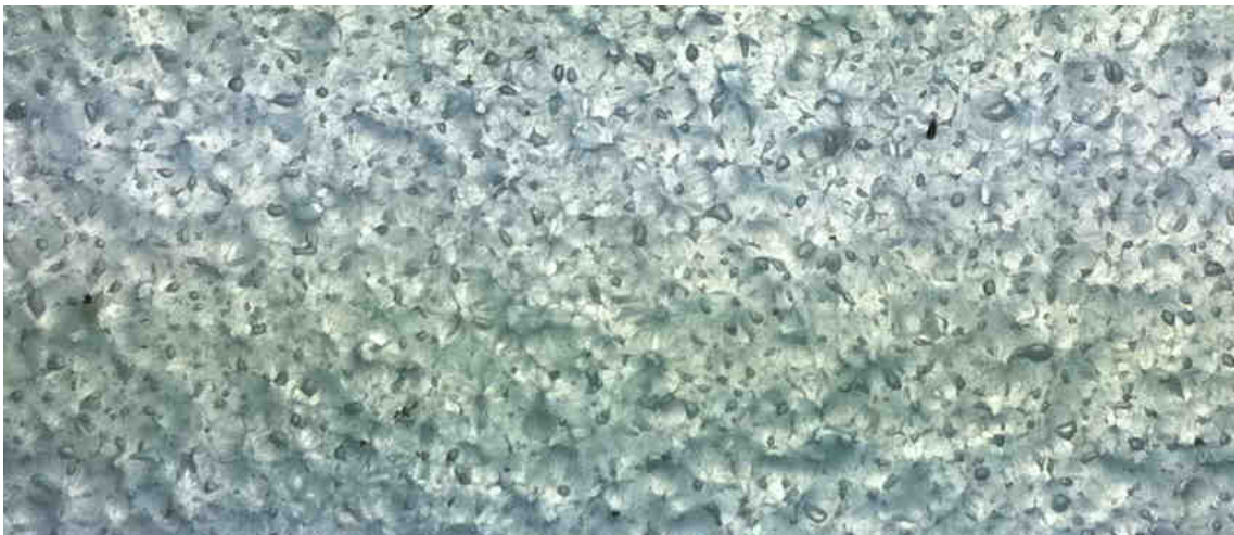
Figura 6.56: Imagen ampliada de cara inferior o fondo de pieza número 21, a 140 °C y 40 minutos de calentamiento. Imagen análoga a la figura 6.53.
