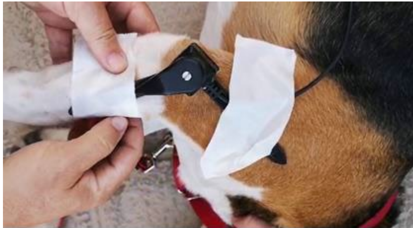
Colocación de un electrogoniómetro sobre la articulación del codo
