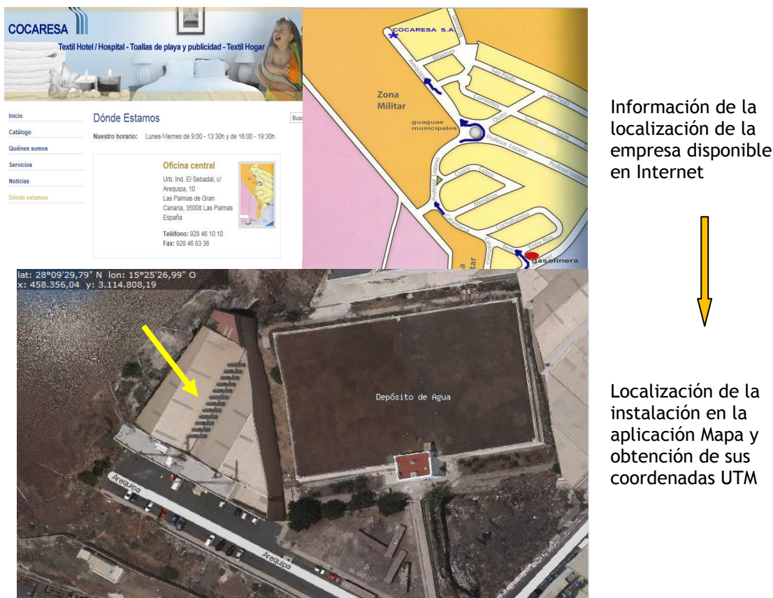
Figura III.40. Localización de instalaciones fotovoltaicas a partir del registro de instalaciones de producción de energía eléctrica.
