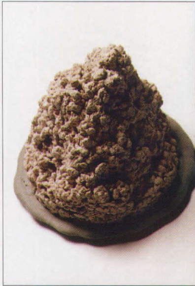
Foto 3: Hormigón ligero de puzolana, sin finos.
