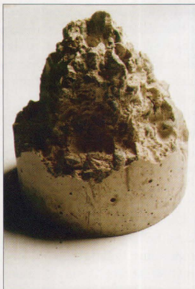
Foto 1: Probeta ensayada de hormigón normal.
