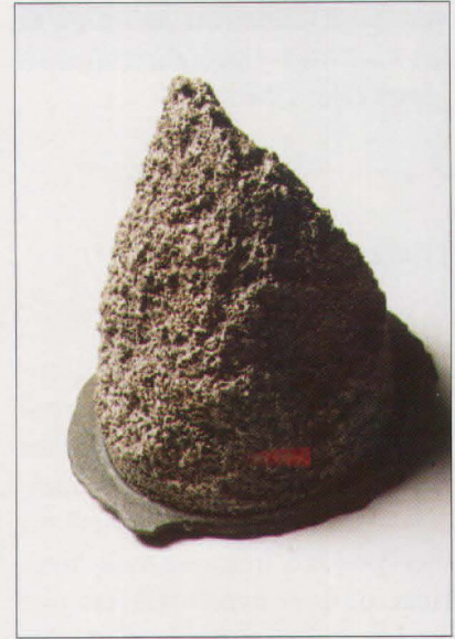
Foto 5: Hormigón ligero de picón.
