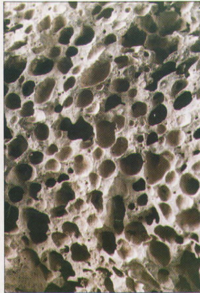
Foto 4: Estructura porosa de pumita.
