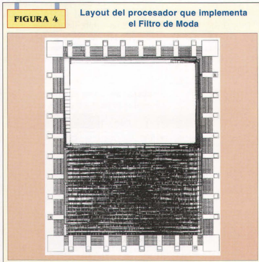
Figura 4: Resaltan la memoria FIFO que se sitúa en el rectángulo superior, y la lógica asociada a los EPs y Registros utilizados para implementar el filtro que aparece en la parte inferior. El chip permite ser utilizado en sistemas que realizan el test del Boundary Scan. El área total del ASIC es de 25 mm 2 .
